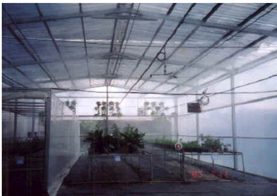
照片 4 善化公司園藝設施高壓噴霧降溫系統性能測定過程中 Escort 溫濕度紀錄器測定情形
