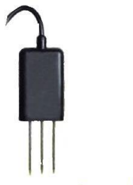
圖 26、墊料含水率感測器
