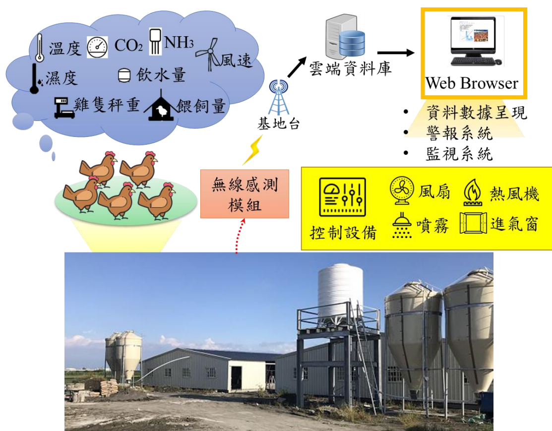
圖 14、智慧化密閉式土雞禽舍系統架構圖
