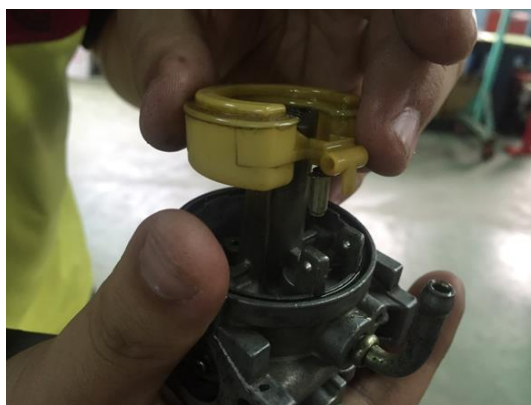
圖 33 吊在浮筒上之小型金屬柱
