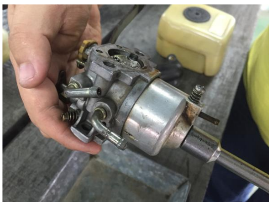
圖 30 拆解化油器上蓋
