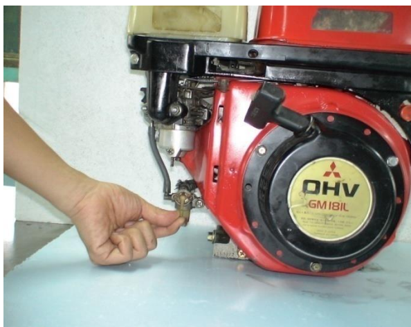
圖 10 打開油箱下方或化油器旁之油杯開關
