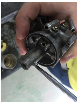
圖 34 以一字起子將主噴油嘴卸除
