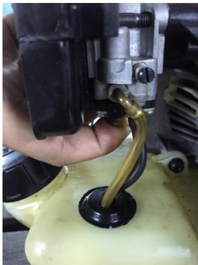
圖 26 按壓油杯下方檢查進出油是否正常
