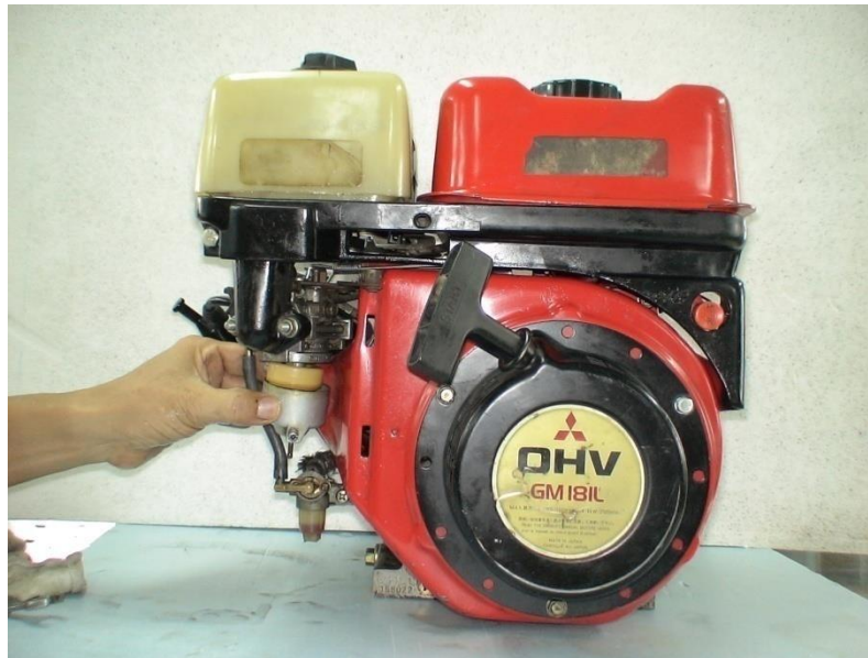
圖 17 將化油器下方排油螺絲放鬆排出殘油，或拆下浮筒室蓋漏掉殘油
