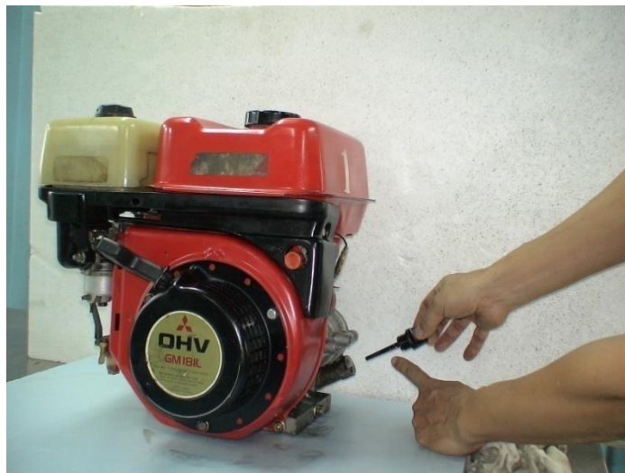
圖 9 四行程引擎曲軸箱內應加入 30 號機油至機油測尺的上下刻度之間
