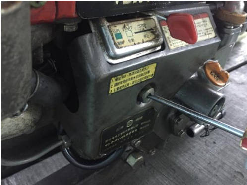
圖 38 以十字螺絲起子將前飾板拆除
