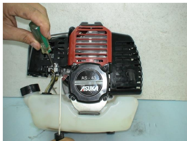
圖 16 各油路螺絲應按規定圈數調整裝回
