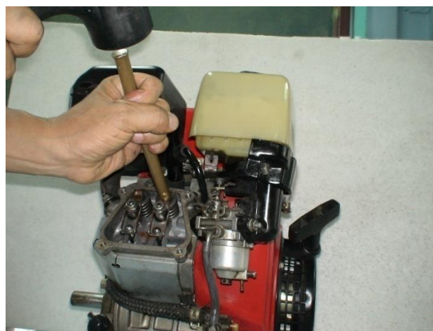
圖 14 用膠槌輕敲汽門頂部使其鬆動
