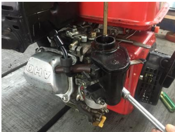
圖 27 拆下空氣濾清器
