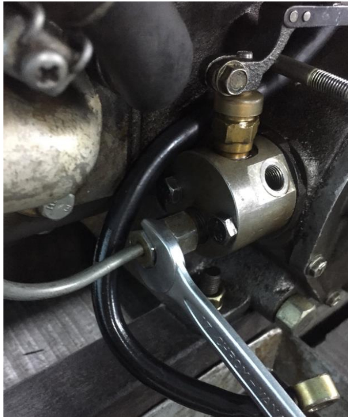
圖 46 柴油引擎狂車時的緊急處理
