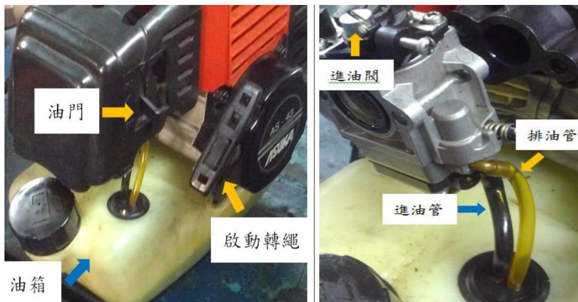
圖 20 二行程汽油引擎各部構造
