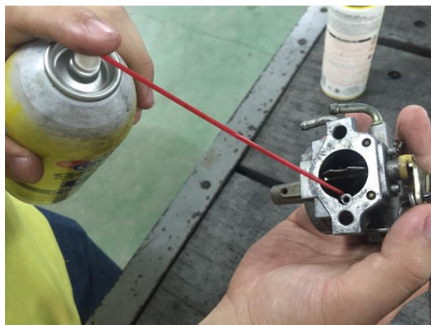
圖 37 以化油器清潔噴劑對化油器進行清潔
