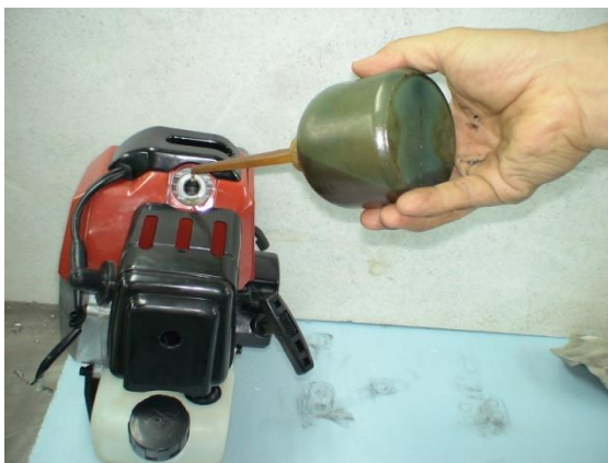
圖 12 拆下火星塞並由火星塞孔滴入數滴機油
