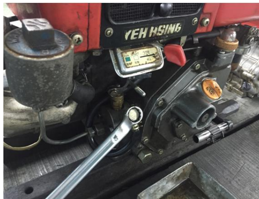
圖 40 以 19 號梅花板手將油管自燃油幫浦本體上卸除
