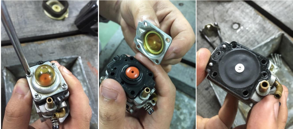
圖 24 膜片式汽油泵化油器連續拆解圖
