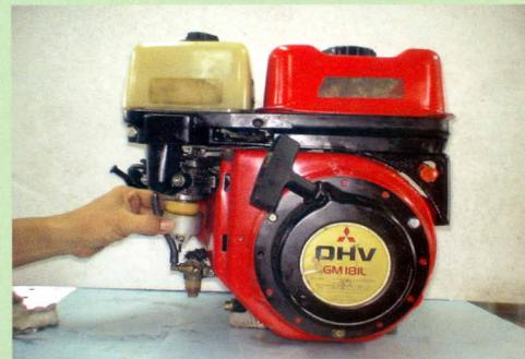
圖 13.將化油器下方排油螺絲放鬆排出殘油，或拆下浮筒室蓋漏掉殘油。
