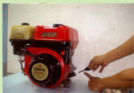
圖 5.四行程引擎曲軸箱內應加入 30 號機油至機油測尺的上下刻度之間。
