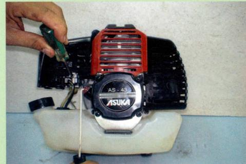
圖 12.各油路螺絲應按規定圈數調整裝回。
