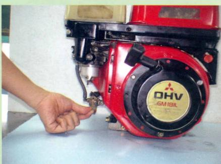
圖6.打開油箱下方或化油器旁之油杯開關。
