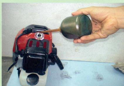
圖 8.拆下火星塞並由火星塞孔，滴數滴機油。
