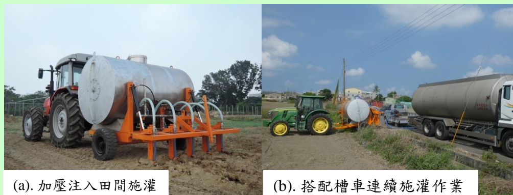
圖 4、加壓注入式糞肥施灌機之田間作業情形
