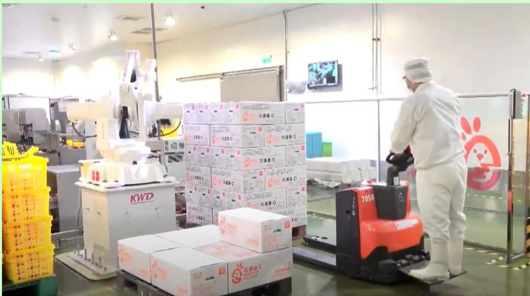
圖 9 堆疊完成的產品由工作人員操作棧板車拖出
