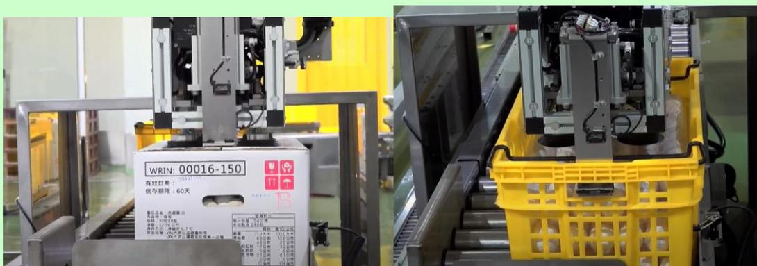
圖 7 夾具透過吸盤吸取紙箱(左)，透過勾爪由內向外勾取塑膠籃(右)
