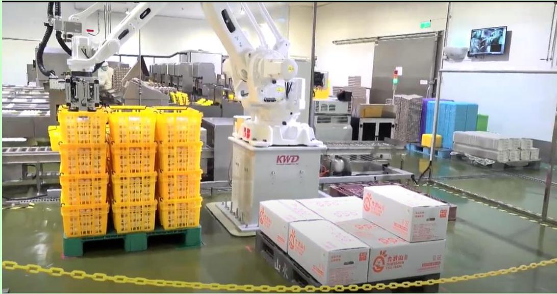
圖 8 機器手臂依據辨識結果自動將貨品堆疊至指定棧位上
