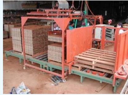
圖17、大棧板型式之疊棧機實地作業情形
