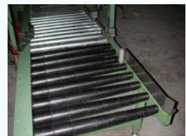
圖6、設計錐型輸送滾筒，使苗箱轉向順利。
