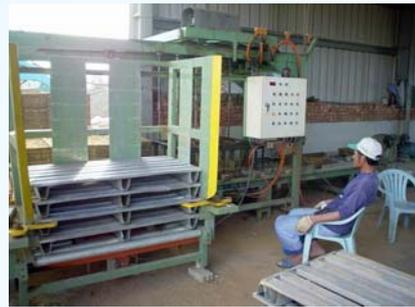
圖18、小棧板型式之疊棧機實地作業情形
