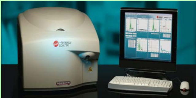
圖3. 自動化精液品質檢測設備-流式細胞儀。
